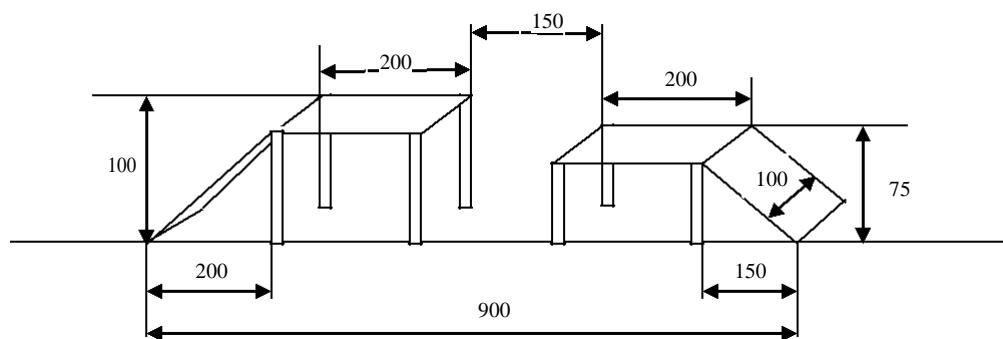
**Бум:** препятствие состоит из бревна длиной 500 см с плоским верхом и двухтрапов, высота над землей 100 см, ширина плоской части бревна и трапов  $\sim 25$  ( $+/- 5$ ) см. На верхнюю поверхность трапов набивают поперечные бруски сечением 20 x 15 мм на расстоянии 20 см один от другого, начиная сверху.
